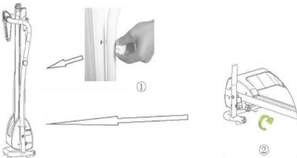
Потяните пружинный болт, как показано на рисунке, и медленно опустите беговую поверхность вниз. Затем надежно затяните ручку снизу.
